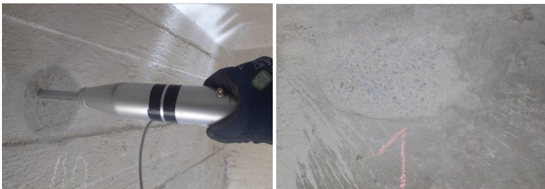
Obr. 2 Meranie Schmidtovým tvrdomerom
