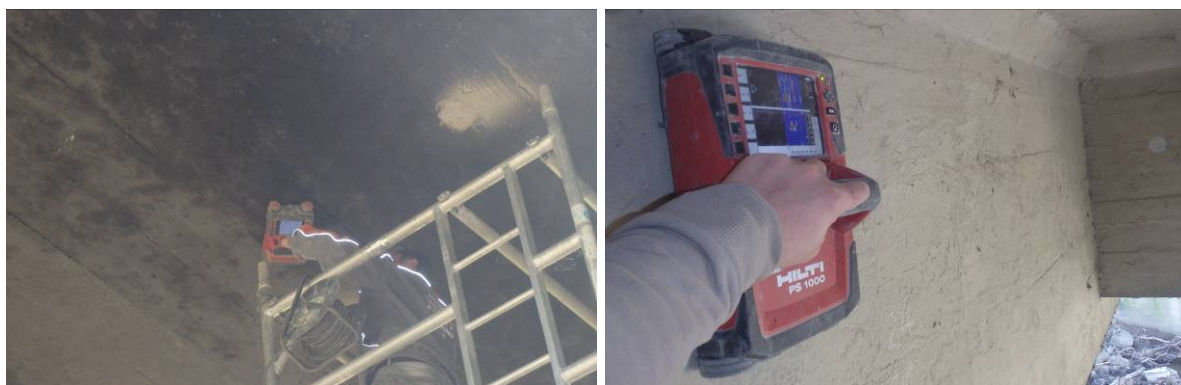
Obr. 4 Nedeštruktívne určovanie polohy výstuže prístrojom CPR Radar PS 1000 X-Scan
