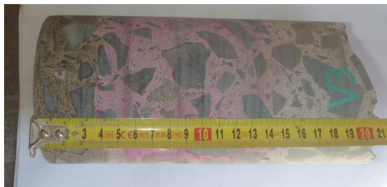
Obr. 6 Nástrek roztoku fenolftaleínu na odobratom vývrte
