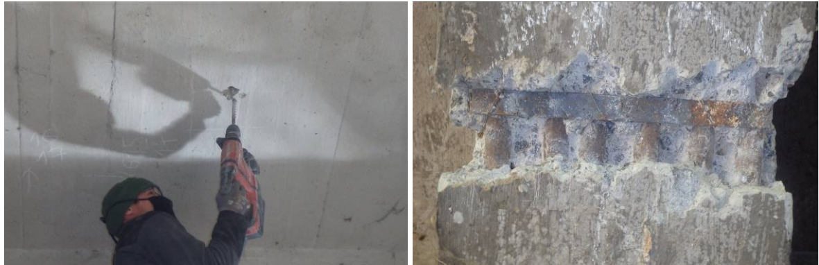
Obr. 5 Deštruktívne určovanie parametrov výstuže
