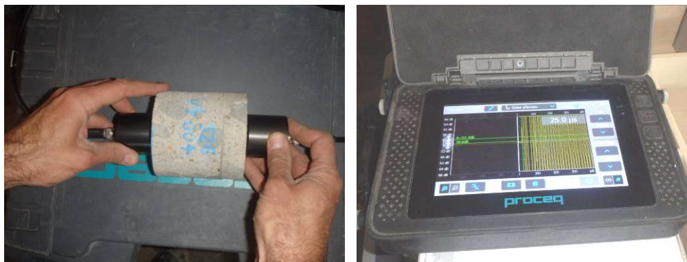
Obr. 3 Meranie modulu pružnosti ultrazvukovou metódou
